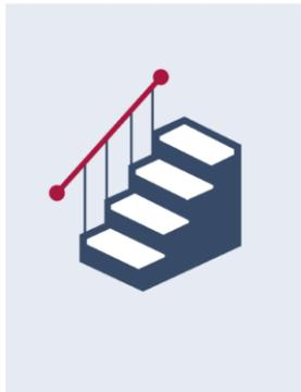
Handlauf muss in Abwärtsrichtung an der rechten Treppenseite montiert sein
